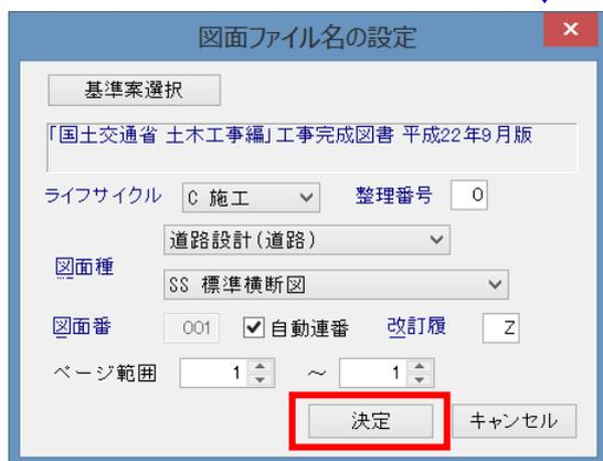
CADへ出力するにあたり、電子納品基準に合わせて出力することが出来ます。ここでは、サンプル的に道路横断図面として設定して「決定」を選択します。
